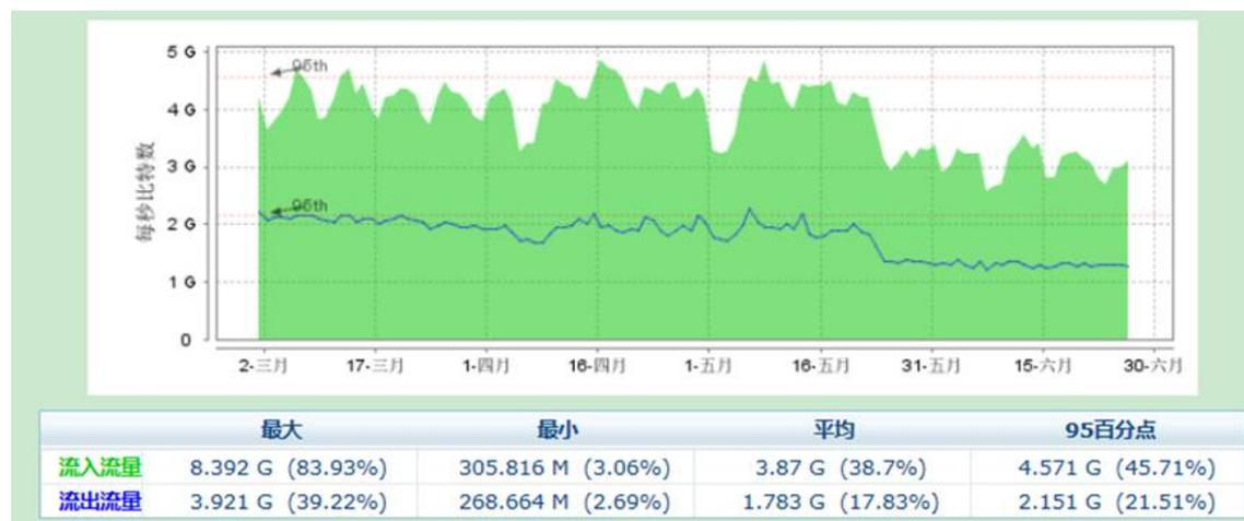
图 2-2-1 城域网 IPv4 上联-1 流量图
